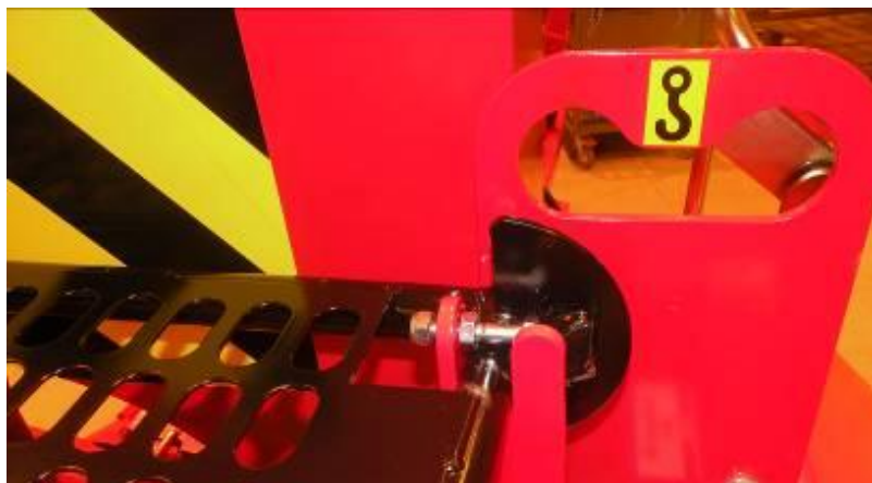
Bild 4. Maskinens lyftpunkter för kedja eller lyftlinor.
