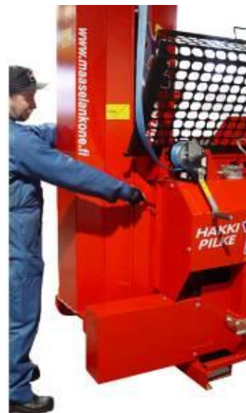
2. Skjut transportören mot maskinen och frigör transportörens låsning genom att lyfta upp låsspaken
