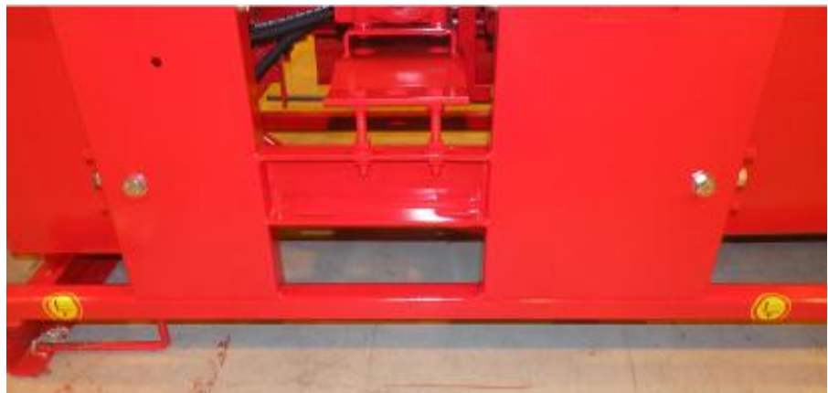
Bild 3. Maskinens lyftpunkter för truckgafflar.
