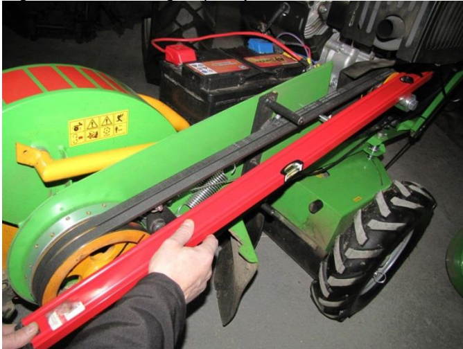
Inriktning av motorns remskiva
