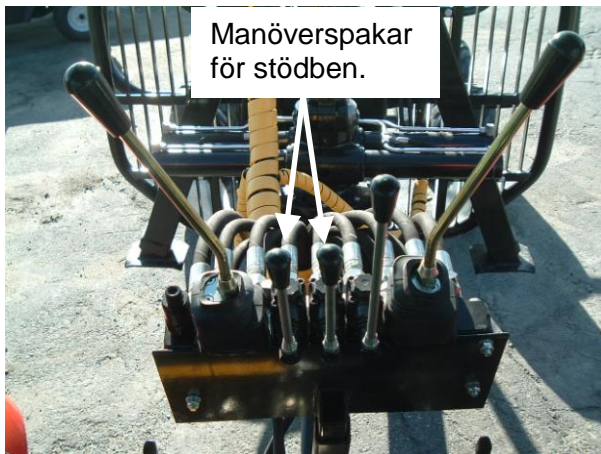
Standardpaket med manöverspakar för kran och stödben.
