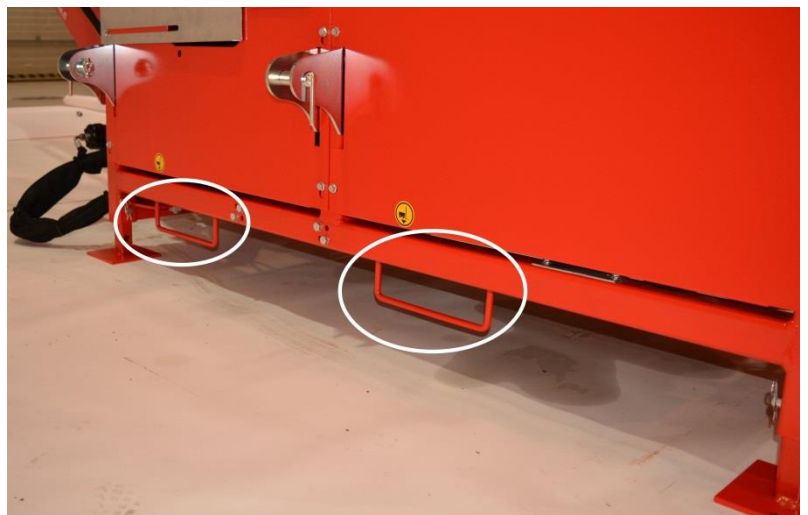
Bild 1a. Maskinens lyftpunkter för truckgafflar (2 st.).
