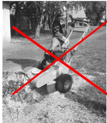
Operatören står vid sidan – inte tillåten position
