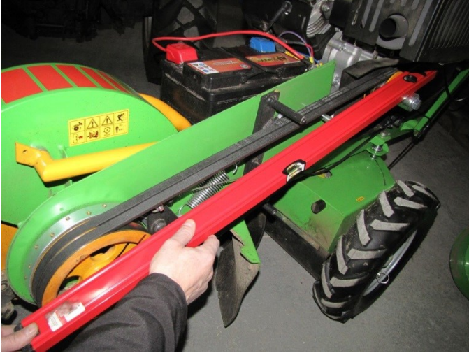
Inställning av linjering på motorns remhjul
