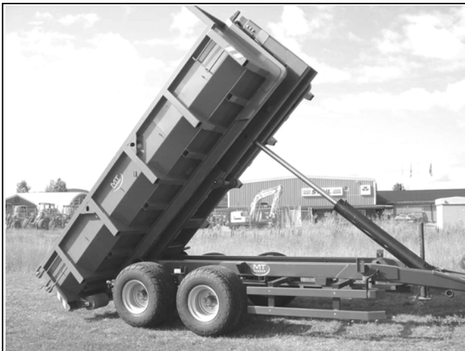
Bild 10 – Tippning av flak (bilden visar MT8-12)
